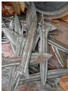
**Gambar 4 proses produksi keris cor dari bahan besi homogen yang dibuat oleh Purbo Baskoro ( 60thn). Pada masa proses pendinginan sebelum difinishing.**
