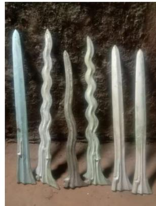
**Gambar 2 Contoh cetakan molding untuk keris cor dari bahan lunak yang dibuat oleh Purbo Baskoro (60thn).**
