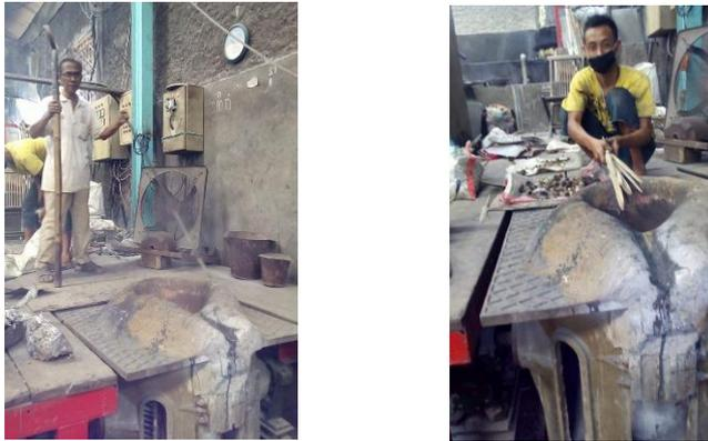
**Gambar 3 proses produksi keris cor dari bahan besi homogen yang dibuat oleh Purbo Baskoro ( 60thn). Tampak tanur sebagai tempat peleburan.
