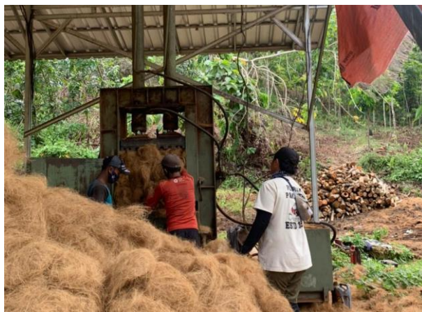
Gambar 2 Mesin Press Cocofiber
